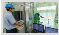
打ち出しから落下するまでの 飛行中のボールを計測し、 スピンの状態や落下時の スピード、角度などを計測 します。
