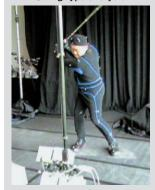
8台のカメラでスイングを撮影し、動きを 解析することにより、最適な数値を 導き出しクラブの開発に役立てます。
