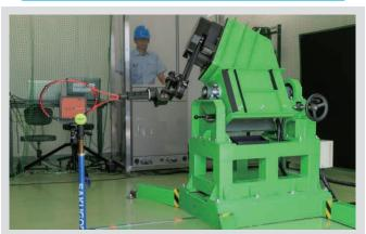
飛距離のほか、ボールの変形挙動、打撃音などフィーリングに関する計測まで総 合的に解析・評価を行っています。
