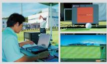
打ち出しから落下するまで飛行中のボールを追尾できる ドップラーレーダーにより、スピンの状態や落下時の スピード、角度などを計測します。
